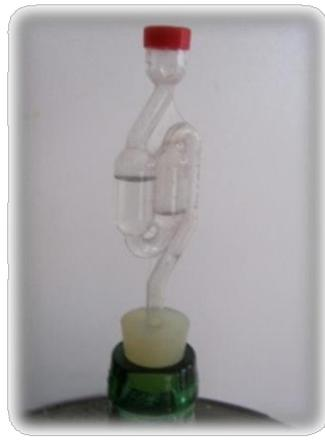
Barboteur → Petit appareil souvent en forme de serpent permettant le dégagement des gaz sans laisser entrer l'air.
