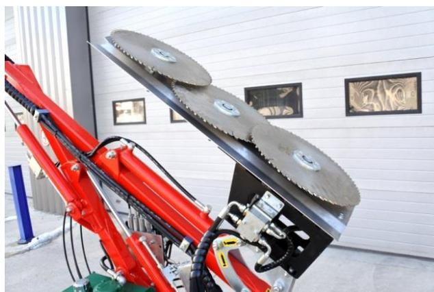
Bras de taille hydraulique avec disques (à monter sur tracteur)
