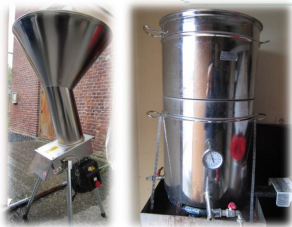
Figure 3: broyeur à pommes, à brancher sur une prise secteur 220V (gauche). Le pasteurisateur (à droite) (alimenté par un bruleur à gaz) a été fixé sur un socle par l'équipe technique afin d'avoir une bonne combustion et éviter les assauts du vent. C'est le seul pasteurisateur transportable pouvant fournir un débit théorique de 100litres/heure.
