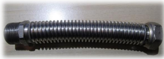
Figure 5: raccord entre le serpentin et la partie supérieure du pasteurisateur
