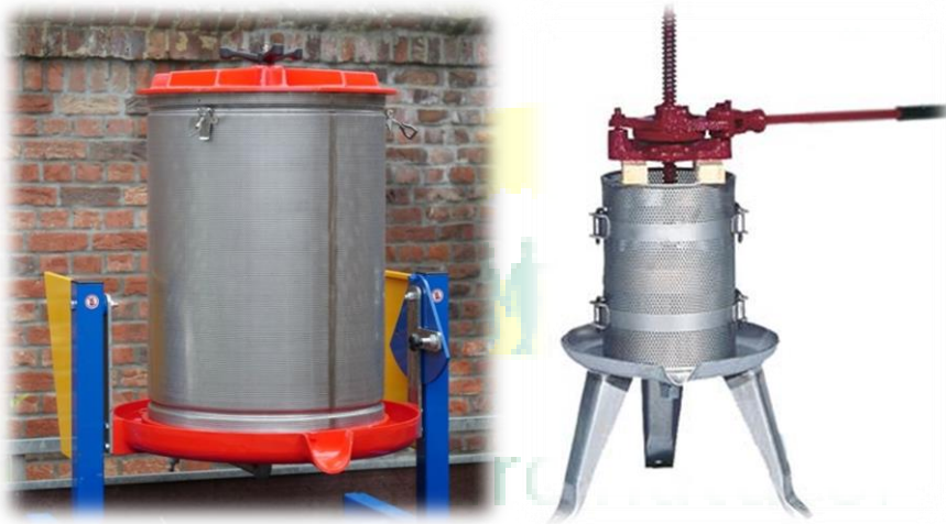
Figure 2 : hydro presseur (gauche): un simple branchement à l'eau de ville permet à une membrane de gonfler et de presser son jus. Il permet de transformer 160kg de matière broyée.
